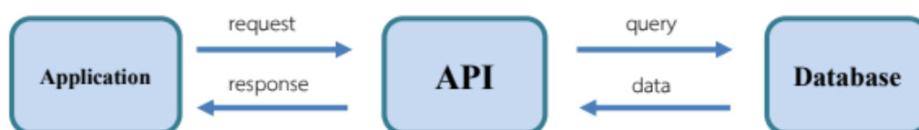
ภาพที่ ๒.๔ ลักษณะการทำงานของ Application Programming Interface
